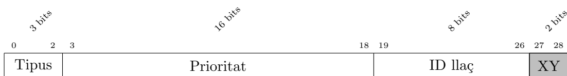
Figura 3.9: Esquema genèric dels identificadors CAN pel nou laboratori.
